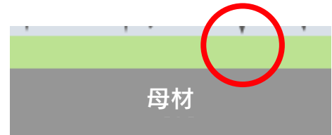
ファインクロムの断面イメージ
