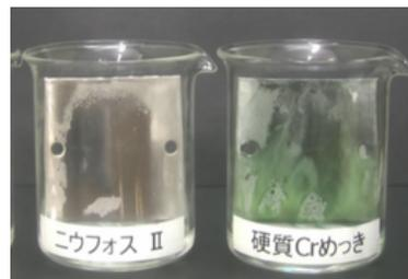
塩素ガスによる耐薬品性試験結果
