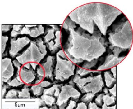
クレーク側面にも微細な凹凸を有しており、高い光の閉じ込め効果が得られている。
