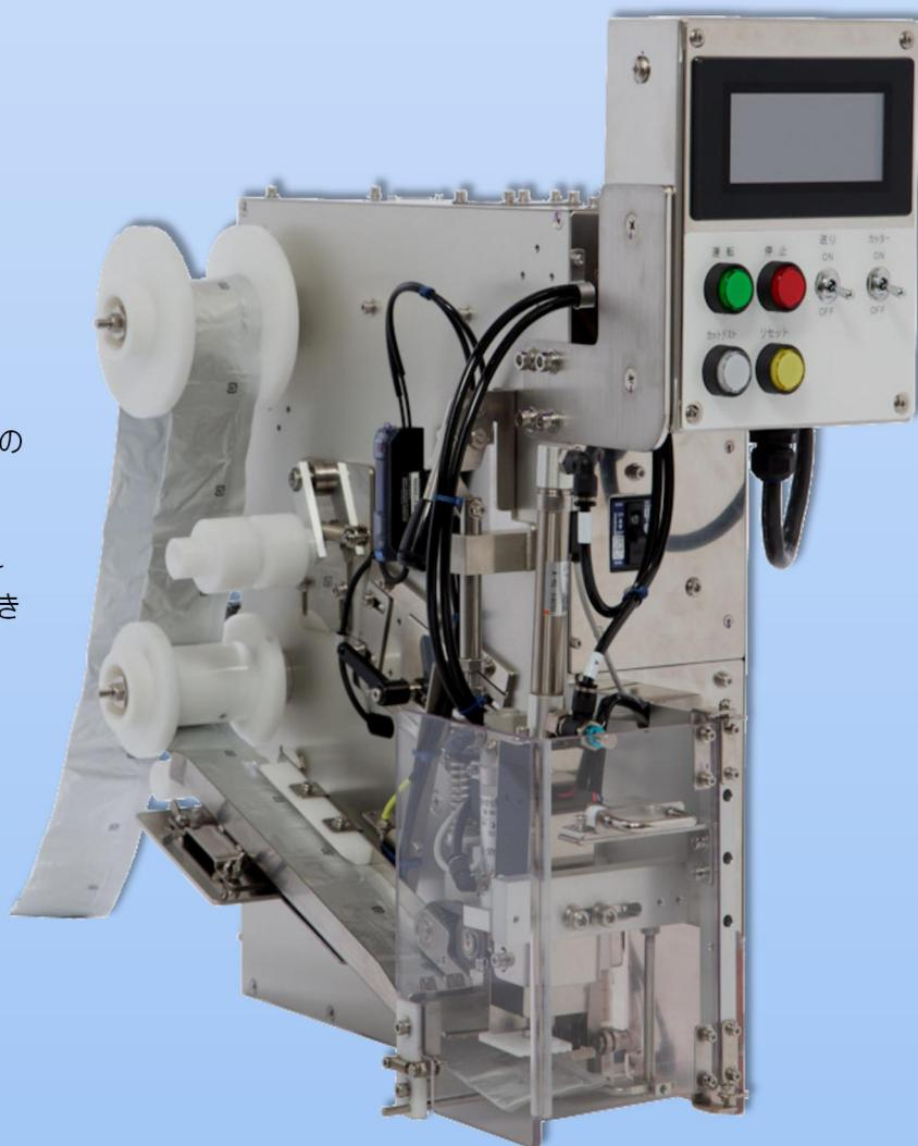
小袋自動投入機は納豆のからし/たれ・粉末/液体スープ・スパイス・乾燥剤・脱酸素剤 等、連包の小袋を高速で正しく投入する装置です。
